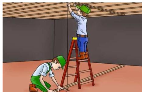
Quando a corda é anexada a um objeto estático e o peso do Prumo de centro está suspenso abaixo, as leis da gravidade assegurarão que a corda seja vertical e perpendicular a qualquer plano horizontal através do qual ele passa.
